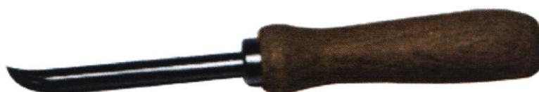
Figur 25. Trådsætter til svejsning i hjørner. Efter svejsningen skal tråden afskæres i niveau med banemes overflade, så vand og snavs ikke samler sig i og omkring svejsefugen. Svejsefuger skal fremstå glatte og ensartede
